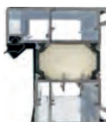
PRZEKRÓJ OŚCIEŻNICY ALUMINIOWEJ TERMO
